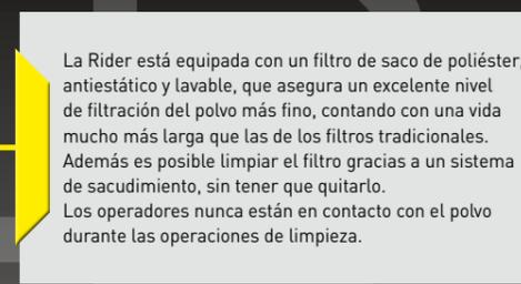
La Rider está equipada con un filtro de saco de poliéster, antiestático y lavable, que asegura un excelente nivel de filtración del polvo más fino, contando con una vida mucho más larga que las de los filtros tradicionales. Además es posible limpiar el filtro gracias a un sistema de sacudimiento, sin tener que quitarlo. Los operadores nunca están en contacto con el polvo durante las operaciones de limpieza.
