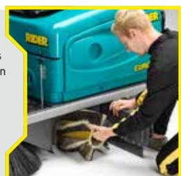
El cepillo central, flotante y auto-nivelante se puede sustituir rápidamente sin utilizar herramientas y los cepillos laterales retráctiles y antichoque garantizan una limpieza excelente incluso de suelos irregulares. En el cepillo central, que tiene una anchura de 70 cm, se unen unas filas de cerdas sutiles, para recoger el polvo fino, y unas filas de cerdas más gruesas, para la recogida de la basura más pesada.
