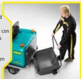
El amplio cajón basura (85 l) reduce el tiempo de inactividad aumentando la productividad total, ya que se puede trabajar con la Rider 1201 durante periodos prolongados sin necesidad de vaciarlo. Un cómodo mango, y las ruedas de apoyo, favorecen el transporte de la basura hasta el sitio de descarga.
