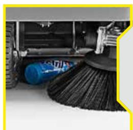
Un mecanismo "levanta-flap delantero" puede ser activado cómodamente desde el asiento del conductor. Esto permite al cepillo central recoger incluso la basura más grande y voluminosa.
