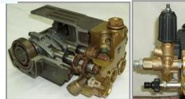
Bomba de cigüeñal y bielas, que es de mucho mejor calidad y válvula by-pass industrial que, como todos sus componentes y conexiones de la hidro, son de manufactura italiana.
